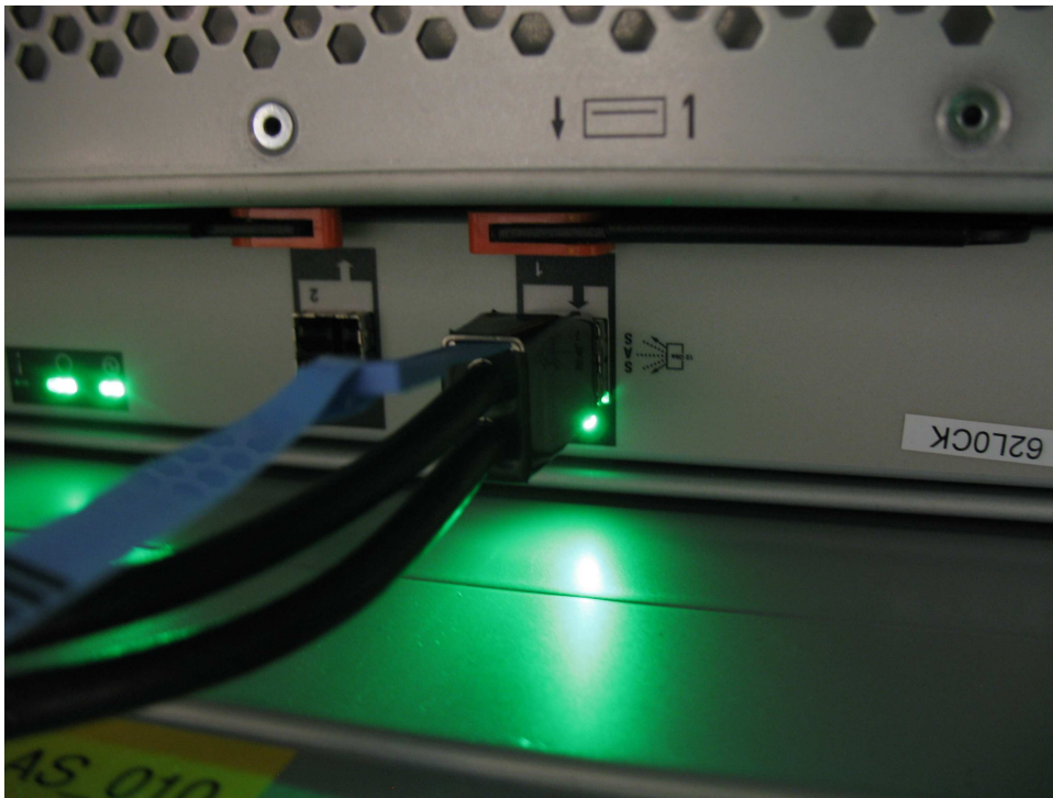
図 70. SAS ポートに正しく挿入された SAS ケーブル
