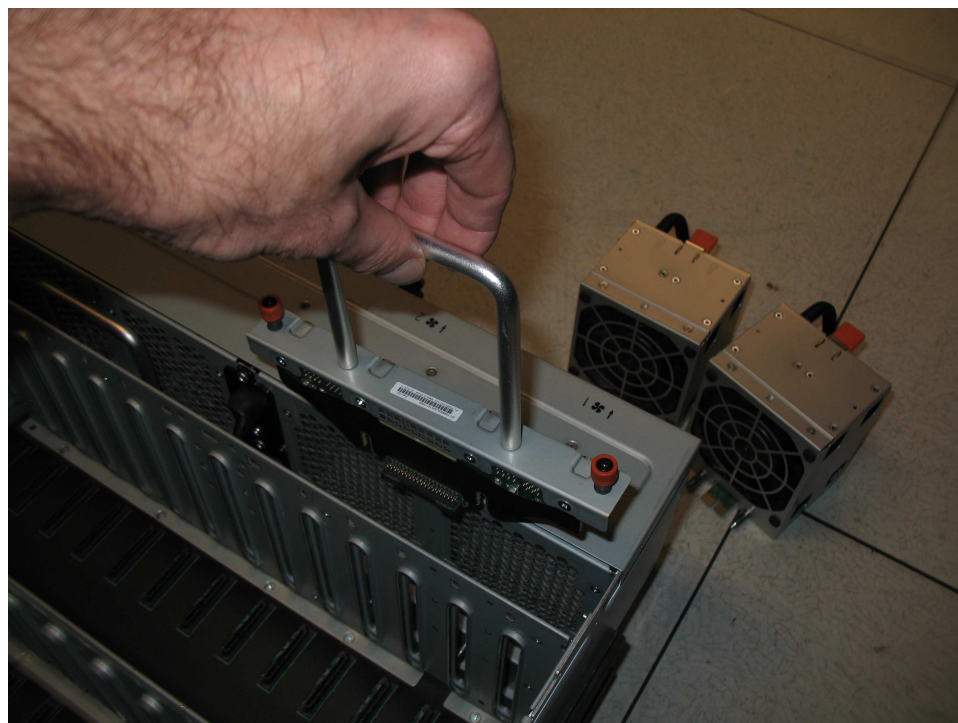
図 74. シャーシへの新規 FIB の装着
